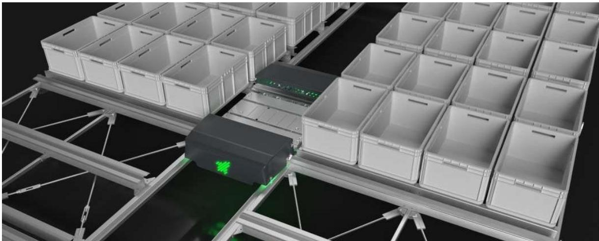
Abb. 10 Beispiel Prinzip Multishuttle-Lager (Quelle: [www.logistra.de](http://www.logistra.de))
