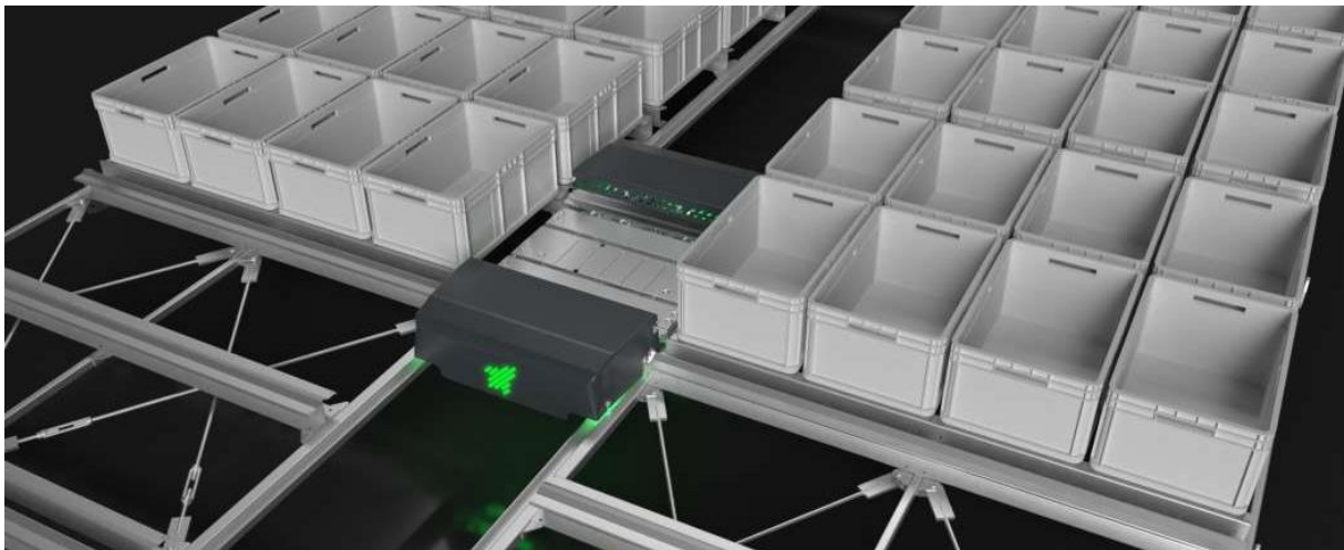
Abb. 10 Beispiel Prinzip Multishuttle-Lager (Quelle: www.logistra.de )
